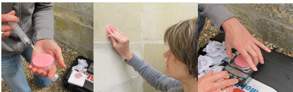
Test à l'éponge sur un parement calcaire à l'abbaye de Chaalis ©LRMH
